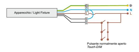
Versione dimmerabile - Collegamento con sistema di gestione DALI Dimmable Version DALI - Management system wiring DALI
