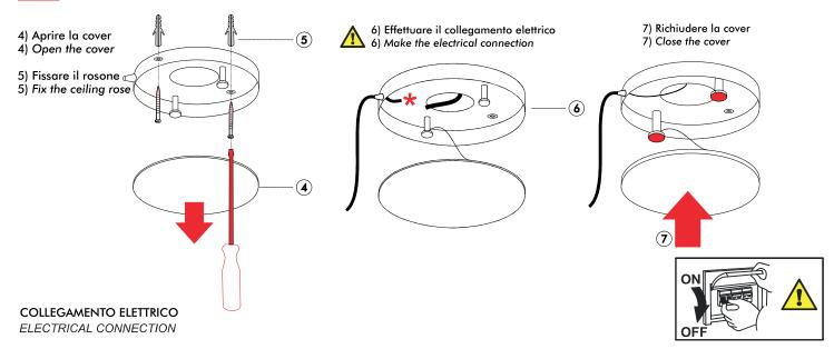
Attenzione! Togliere la rete di alimentazione prima dell'installazione, sostituzione della lampada e comunque prima di ogni operazione di manutenzione.
