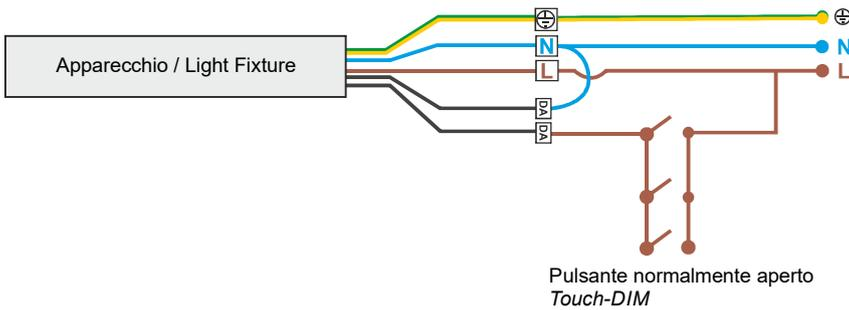
Versione dimmerabile - Collegamento con sistema di gestione DALI
