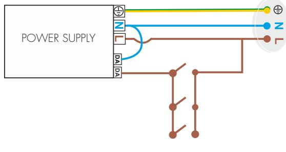
Versione dimmerabile - Collegamento con sistema di gestione
