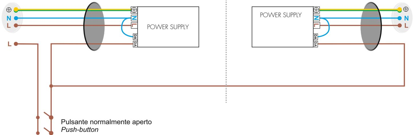
Versione dimmerabile - Collegamento con sistema di gestione
