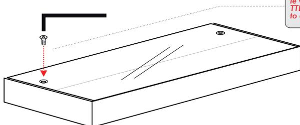
**ATTENZIONE: non stringere eccessivamente le viti per evitare la rottura del diffusore**
