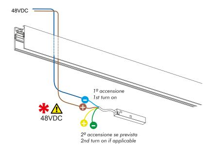
B) Inserire il connettore all'interno del binario. B) Insert the connector into the track.
