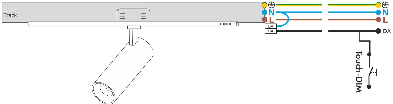
Versione Dimmerabile - Collegamento con sistema di gestione
