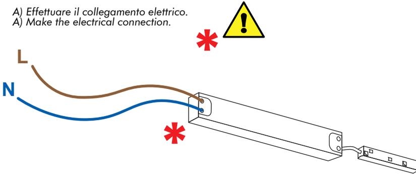
B) Alloggiare l'alimentatore all'interno del binario ed inserire il connettore.
