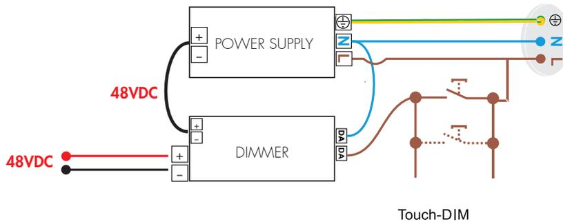
Versione dimmerabile - Collegamento con sistema di gestione
