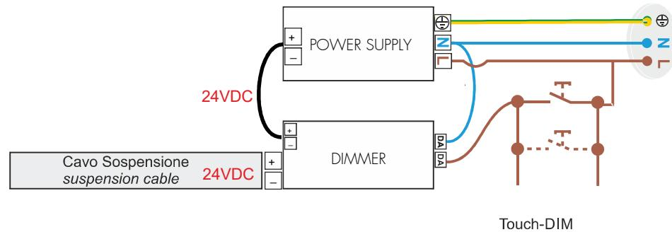
Versione dimmerabile - Collegamento con sistema di gestione
